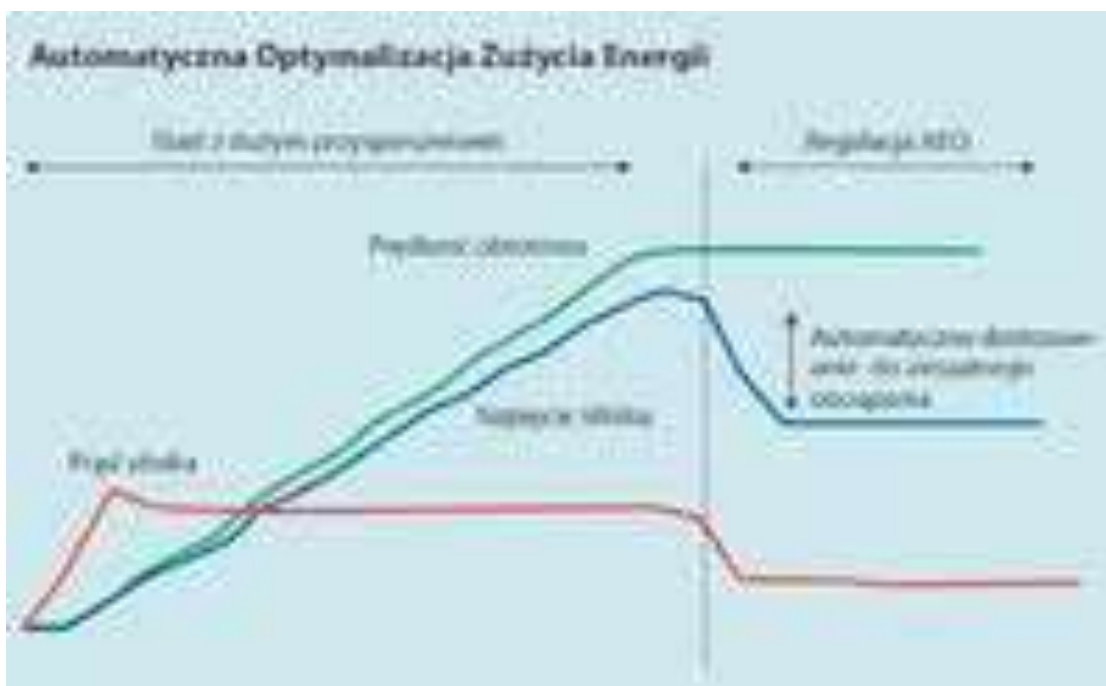
Rys. 1. Dopasowane strategie regulacji umożliwiają energetycznie optymalną pracę - w przetwornicach Danfoss wprowadzono sprawdzoną regulację AEO
